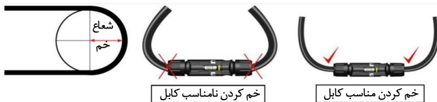
تصویر ۱۶ - خم کاری کابل
