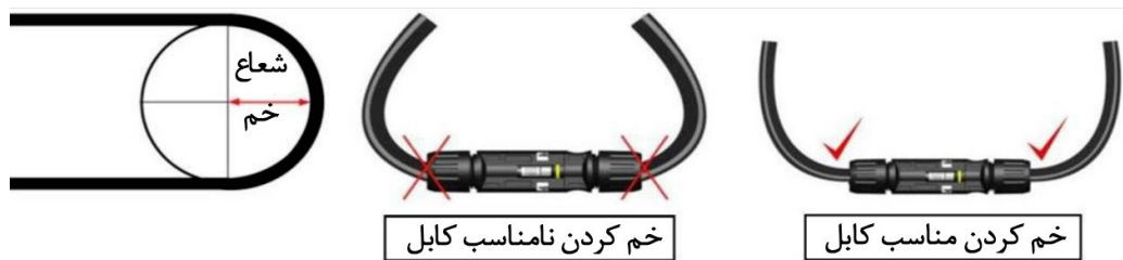
تصویر 16- خم کاری کابل
